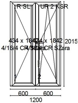
**Porte-fenêtre PVC 2 vantaux avec oscillo-battant seuil ALU 20 mm.**
